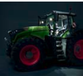
Met de coming-homefunctie blijven de koplampen en de instapverlichting branden nadat de tractor is weggezet zodat de weg naar huis en de treden verlicht blijven.
