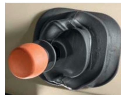
Handremassistent in automatische stand: De handrem wordt automatisch aangehaald.
