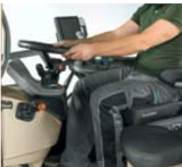
Voor nog meer bedieningscomfort draait het dashboard parallel met het stuur.
