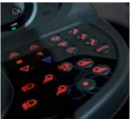
De omgevingsverlichting creëert een prettige atmosfeer bij nachtwerk. Alle functionele elementen hebben achtergrondverlichting.
