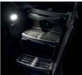
De instapverlichting die in de zijkant van de tank is geïntegreerd, garandeert veilig in- en uitstappen.
