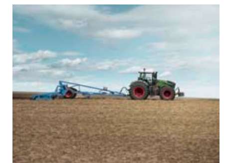
Dankzij het TMS-tractorbeheersysteem en de automatische automatische grenslastregeling 2.0 past de tractor het motortoerental optimaal aan de rijnsnelheid aan.
