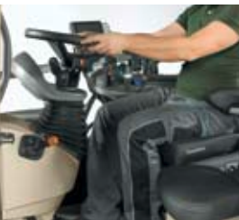
Voor nog meer bedieningscomfort draait het dashboard parallel met het stuur.
