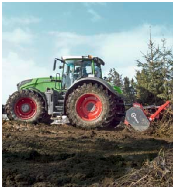
Wanneer u in achteruitrijstand werkt, kunnen alle bedieningselementen even comfortabel worden bediend als in vooruitrijstand. Het hele bestuurdersstation wordt gewoon 180° gedraaid, en al het andere in de cabine blijft waar het was. Ondanks het omgedraaide bestuurdersstation hoeft de rijder zijn comfortabele stoel niet op te geven.
