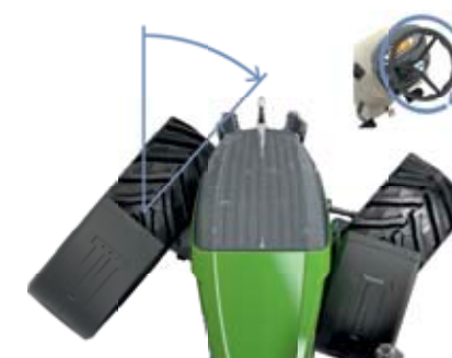
Met VarioActive maakt u een volledige stuuruitslag met slechts één draai aan het stuur.
