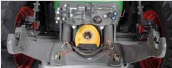
De fronthefinrichting is volledig geïntegreerd in het half-frame en daardoor bijzonder stabiel. De trekstangen van de fronthef kunnen diagonaal omhoog worden geklapt, wat de vrije ruimte bij voorladerwerkzaamheden groter maakt.
