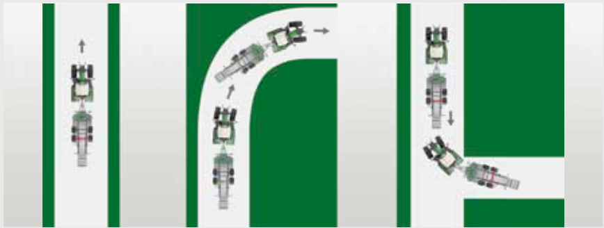
Met de optionele automatische stuurasblokkering wordt de gestuurde naloopas van aanhangwagens binnen een in te stellen snelheidsbereik automatisch ontgrendeld. Op de rechte lijn zorgt de stijve naloopbesturing voor een stabiel rijgedrag. De bestuurder hoeft de naloopbesturing buiten het geselecteerde snelheidsbereik en tijdens achteruitrijden niet handmatig te blokkeren.
