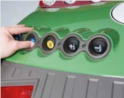
Bovendien kan één ventiel buiten de cabine (op het achterspatbord) worden bediend, wat het aan- en afkoppelen van werktuigen gemakkelijker maakt.
