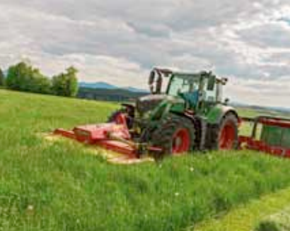
De ontlastende fronthefregeling is speciaal gun- stig bij gebruik van een sneeuwplough en bij wer- ken met een frontmaaier op grasland, omdat de werktuig- geleiding zich zeer snel aan bodemoneffenheden aanpast.
