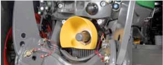
De geïntegreerde frontaftakas levert 1000 t/min. Door de directe krachtoverbren- ging van motor naar werktuig wordt een groter rendement behaald. Een ander voordeel van de opklapbare trekstangen is dat werktuigen dichter tegen de trek- ker aan kunnen worden gebouwd en dat de voorbanden beter toegankelijk zijn.
