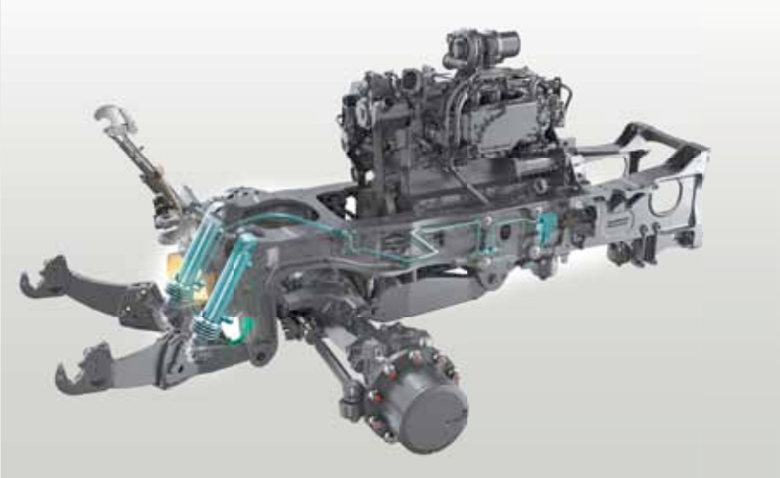
De ontlastende fronthefregeling is speciaal gun- stig bij gebruik van een sneeuwplough en bij wer- ken met een frontmaaier op grasland, omdat de werktuig- geleiding zich zeer snel aan bodemoneffenheden aanpast.
