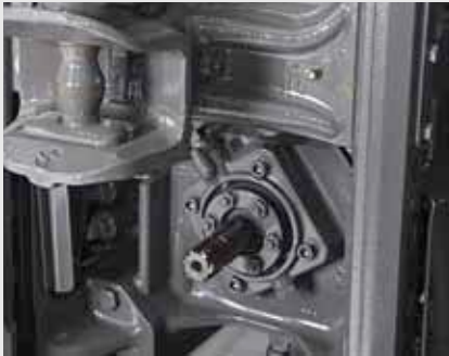
Achterste aftakas met snelheden 540, 540E, 1000 en 1000E (t/min). Erg handig is de externe bediening van de aftakas aan de achterzijde.
