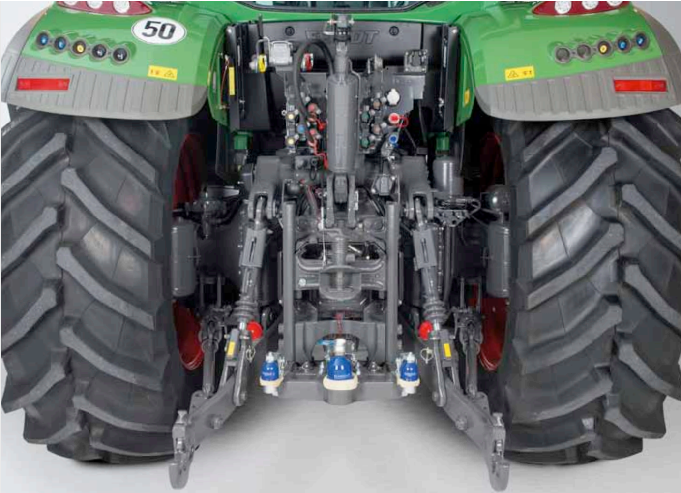
Alle aansluitpunten zijn functioneel en overzichtelijk aan de achterkant van de trekker aangebracht: hydraulische topstang, stuurventielen (maximaal 5), drukloze retourleiding, luchtdrukrem, druk- en stuurleiding voor Power Beyond, hydraulische aanhangwagenrem, 7-polige contactdoos, vanghaken voor de trekstangen, contactdoos voor ABS, ISOBUS-contactdoos, trekhaak, achterste aftakas 540, 540E, 1000 en 1000E, onderaanspanning, stuurasautomaat.
