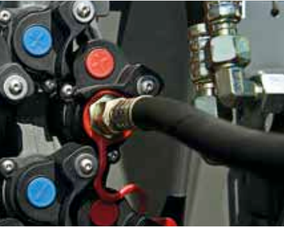
Via de DODK-koppelingen kunnen hydrauliekven- tielen van werktuigen onder druk worden aange- sloten. Hierdoor kunnen werktuigen snel en eenvoudig worden aan- en afgekoppeld. De zelfsluitende ventielklep- pen vormen een betrouwbare bescherming tegen vervui- ling, zoals door stof of water.
