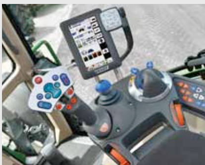
De stuurventielen zijn praktisch aan te sturen via de kruishendel en de multifunctionele joystick.
